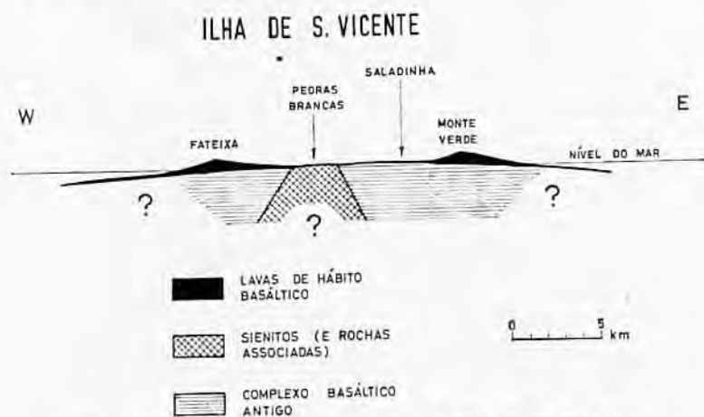
Fig. 3 — Corte geológico esquemático da ilha de S. Vicente: (os sienitos indicados são nefelínicos)
